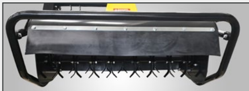
Rotore di taglio a 46 coltelli da 80 cm - 80 cm cutting rotor with 46 blades
